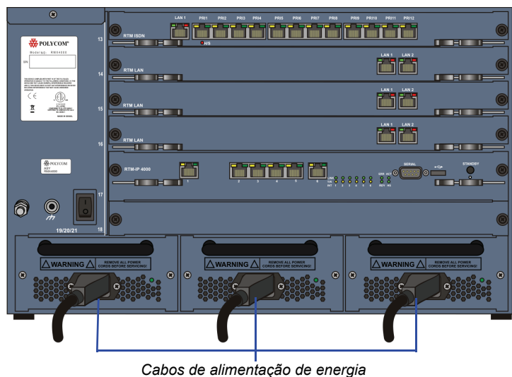
Figura 2-1 RMX 4000 Vista do painel traseiro com energia elétrica CA
